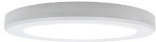
Die Acero Flex ist eine Ein- und Aufbauleuchte mit einem integriertem LED-Panel. Dank dem phasendimmbaren Treiber und des schwarzen, sowie silbernen Wechselrahmens, ist sie vielseitig einsetzbar. Durch ein verstellbares Klemmsystem lässt sie sich in Deckenausschnitte zwischen Ø68mm und Ø205mm verbauen.
