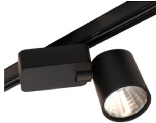
Der Shop:master ist ein hochwertiger, passiv gekühlter Aluminiumdruckguss-Strahler mit Euroadapter für die Tricelest Dreiphasen Stromschiene. Es stehen unterschiedliche Reflektoren mit Spot, Semi, Medium und Flood Abstrahlcharakteristik zur Verfügung. Die unterschiedlichen Reflektoren werden werkzeuglos gewechselt. Alle Shop:master Strahler verfügen über eine Glasscheibe zum Schutz der LED.
