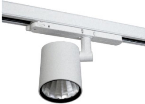
Der Lux:master ist ein hochwertiger, passiv gekühlter Aluminiumdruckguss-Strahler mit Euroadapter für die Tricelest Dreiphasen Stromschiene. Es stehen unterschiedliche Reflektoren mit Spot, Semi, Medium und Flood Abstrahlcharakteristik zur Verfügung. Die unterschiedlichen Reflektoren werden werkzeuglos gewechselt. Alle Lux:master Strahler verfügen über eine Glasscheibe zum Schutz der LED. Die LED COB Platinen sind austauschbar.
