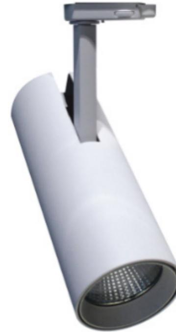
Der CeTube ist ein hochwertiger, passiv gekühlter Aluminiumdruckguss-Strahler mit Euroadapter für die Triclest Dreiphasen Stromschiene. Die LED COB Platinen sind durch Schrauben am Kühlkörper befestigt und können ausgetauscht werden. Sein geradliniges Design fügt sich optimal in Räumlichkeiten ein und erzeugt Klarheit und Kontinuität. Durch die rasante Entwicklung der LED Technik werden die COB Platinen permanent dem Stand der Technik angepasst.
