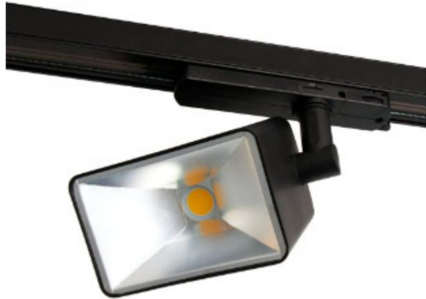
Der Square ist ein hochwertiger, passiv gekühlter Aluminiumdruckguss-Strahler mit Euroadapter für die Triclest Dreiphasen Stromschiene. Er ist sowohl dreh als auch schwenkbar. Neu ist die homogene Abstrahlcharakteristik des eckigen Reflektors – dieser sorgt horizontal für eine gleichmäßige, nahezu decken-bündige Ausleuchtung, und das auch bei großen Abständen oder Raumhöhen. Die LED COB Platinen sind austauschbar.
