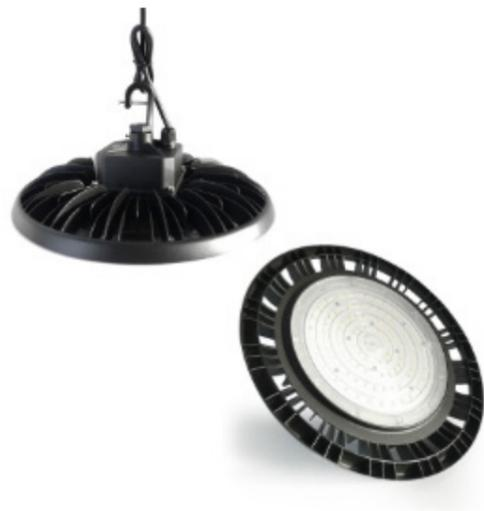
Die X-Disk ist eine runde Pendelleuchte, welche aus Druckguss gefertigtem Aluminium besteht. Der Hallenfluter ist IP65 geschützt und daher vielseitig im Innen- und Außenbereich einsetzbar. Dank neuester LED Technologie können Sie bis zu 70% Energie einsparen, ohne an Lichtstärke einbüßen zu müssen. Das Druckausgleichsventil verhindert Kondenswasserbildung in der Leuchte und bleibt so langlebig.
